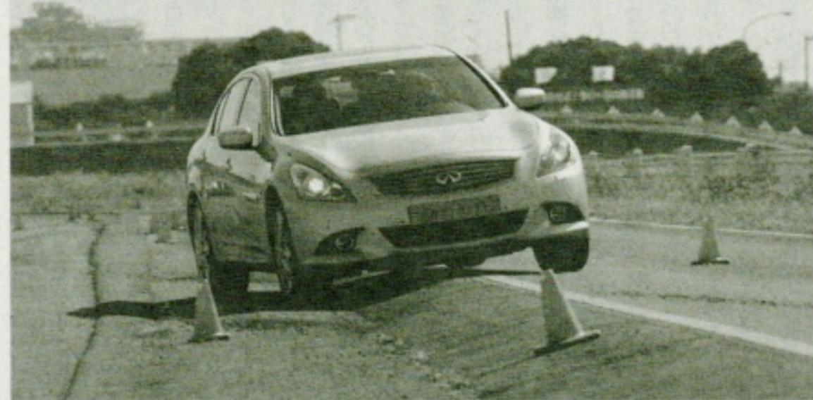
▲日産は先進技術説明会2012&試乗会で次世代のステアリング技術を発表。これはハンドルの動きからドライバーの意図を読み取り、電気信号に置き換えてタイヤを操舵するというもの。また、道路前方の写真の方向を認識し、自車の進行方向とのズレを認識した時に、そのズレを低減するようにタイヤ角とハンドル制御する機能も盛り込んだ。この技術自体は素晴らしいが、人間の安全に対する意識改革とスキルアップも必要だと太田は考える（写真はテスト車両での試乗）
