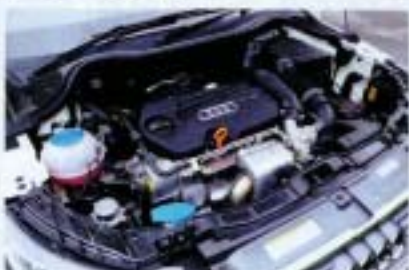
フォルクスワーゲンでいうTFSIをオーディオではTFSIと呼ぶ。1.4Lターボエンジン搭載。
