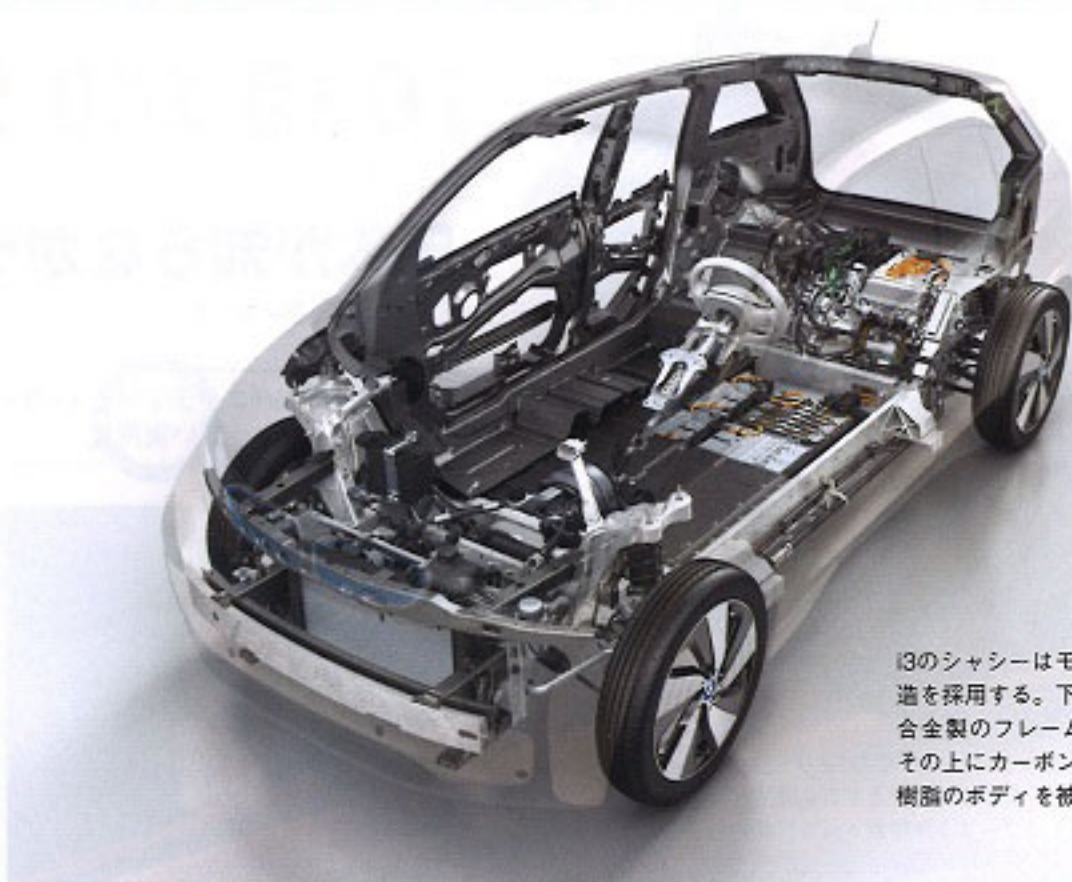
モーターやレンジエクステンダー用のパワートレインはリアに搭載される。発電用の2気筒エンジンは647ccで、よく聞くとコトコトという音が聞こえる。
