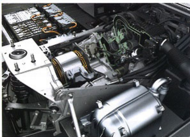
モーターやレンジエクステンダー用のパワートレインはリアに搭載される。発電用の2気筒エンジンは647ccで、よく聞くとコトコトという音が聞こえる。
