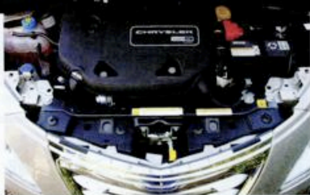
フィアット500などでもお馴染みの、2気筒ターボツインエアエンジンを搭載。
