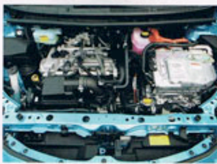
先代プリウスの1.5ℓハイブリッドユニットを大幅改良して搭載している。
